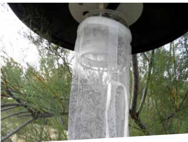
Trampa CDC Miniature Light Trap con adultos de simúlidos. Foto: Ignacio Ruiz Arrondo.
